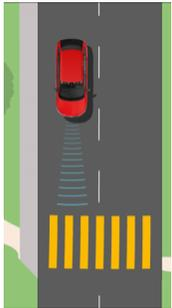
**Front Assist** : Préviend des dangers et des conséquences d'une collision avec le véhicule de devant. Dès que le véhicule se rapproche trop de celui de devant, une alerte sonore et visuelle apparaît. Dans certaines situations critiques, le système peut même amorcer le freinage.
