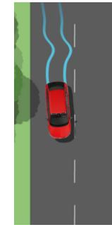
**Détecteur de fatigue** : Au-dessus de 65 km/h, les mouvements du conducteur sur le volant sont analysés en temps réel. Si le système détecte des comportements anormaux, une alerte s'affiche sur l'ordinateur de bord Maxi-Dot en recommandant d'effectuer une pause.
