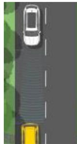
**Régulateur de vitesse adaptatif ACC** : Maintient une vitesse constante et calcule la distance avec le véhicule qui précède. La vitesse est ainsi constamment adaptée en fonction des conditions de circulation. Actif dès 30 km/h et jusqu'à 210 km/h.
