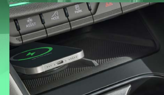
Dispositif Phonebox : recharge par induction avec fonction MagSafe (puissance jusqu'à 25W) et ventilation active pour un téléphone, avec espace de rangement pour le second téléphone
