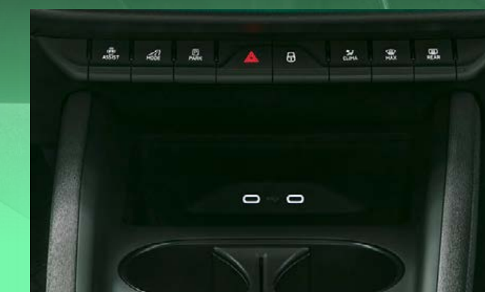
2 prises USB-C 45W à l'avant (recharge et transfert de données) et 2 prises USB-C 45W à l'arrière (recharge uniquement)
