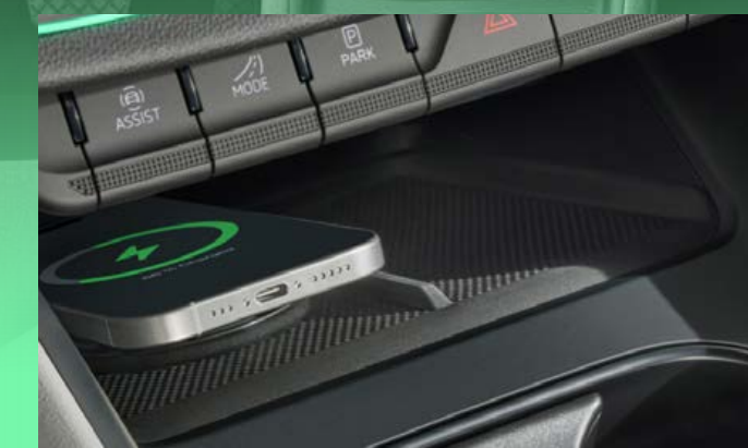
Dispositif Phonebox : recharge par induction magnétique (puissance jusqu'à 25W) et ventilation active pour un téléphone, avec espace de rangement pour le second téléphone
