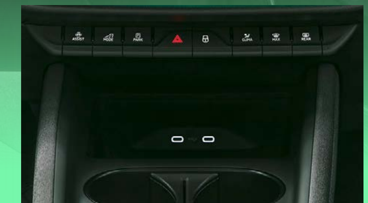
2 prises USB-C 45W à l'avant (recharge et transfert de données) et 2 prises USB-C 45W à l'arrière (recharge uniquement)
