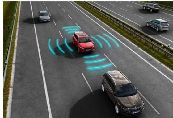
**Emergency Assist :** Si le Lane Assist détecte l'absence des mains du conducteur sur le volant, même après un signal d'alerte, il ralentit la voiture jusqu'à l'arrêt en la maintenant dans la voie, avec les feux de détresse allumés. L'assistance d'urgence est disponible pour les véhicules équipés de DSG
