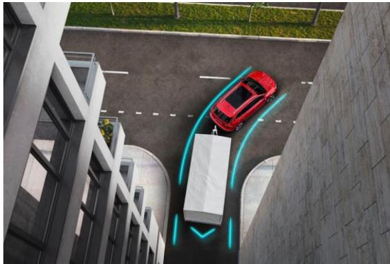
**Trailer assist :** Le Trailer Assist aide lors de la marche arrière avec une remorque, en dirigeant automatiquement la cargaison remorquée dans la direction souhaitée. Pendant la manœuvre de stationnement, la vision 360° offre au conducteur une vue d'ensemble parfaite de la situation
