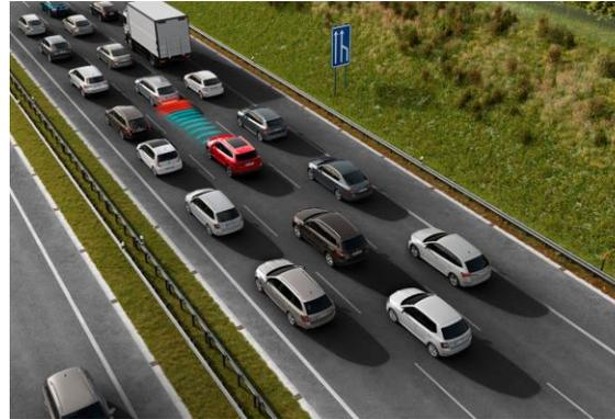
**Assistant de conduite en embouteillage :** Combine Régulateur adaptatif et Lane Assist pour maintenir le véhicule dans sa voie, à moins de 60 km/h. Direction, freinage, accélération sont automatiques si les mains restent sur le volant. Uniquement disponible pour les véhicules avec DSG)
