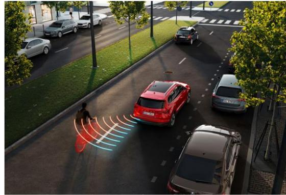
**Side Assist :** Avec l'aide de deux capteurs radar sous le pare-chocs arrière, le Side Assist surveille la zone derrière et à côté du véhicule. Si le système détecte un véhicule dans l'angle mort (jusqu'à 70m), un signal lumineux s'active sur le montant intérieur du rétroviseur.
