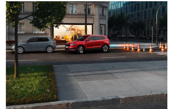
**Manoeuvre Assist :** Il diminue le risque de collision quand la voiture recule (de 1,5 à 10 km/h). Dès que le système détecte un obstacle (statique ou mobile) présentant un risque de collision, les étriers sont automatiquement activés et le véhicule est immobilisé.
