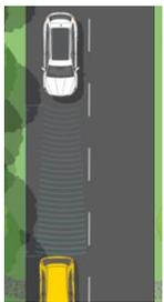
**Régulateur de vitesse Adaptatif** : Maintient une vitesse constante et calcule la distance avec le véhicule qui précède. Si besoin, il décélérera de 3,5m/s. Lié au Front Assist, il alertera le conducteur et décélérera jusqu'à 8 m/s selon les contions de roulage en cas de danger.
