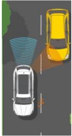
**Side Assist** : Si le système détecte un véhicule dans l'angle mort (à partir de 70m), un signal lumineux s'active sur le montant intérieur du rétroviseur.
