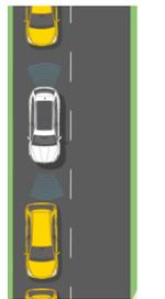
**Assistant de conduite en embouteillage** : Combine Régulateur adaptatif et Lane Assist pour maintenir le véhicule dans sa voie dans une file, à moins de 60 km/h. Direction, freinage, accélération (avec une boîte DSG) sont automatiques si les mains restent sur le volant.
