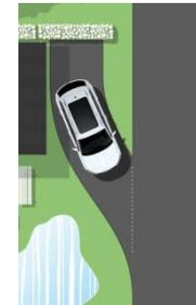
**Manoeuvre Assist :** Il diminue le risque de collision quand la voiture recule (de 1,5 à 10 km/h). Si un obstacle (statique ou mobile) se trouve derrière la voiture, le frein s'active automatiquement.
