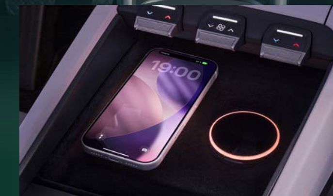
Dispositif Phonebox : recharge par induction magnétique (puissance jusqu'à 25W) et ventilation active pour deux téléphones
