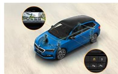
**Chassis Sport Select** : couplé à un rabaissement du véhicule de 15mm, le système offre au conducteur 2 lois d'amortissement : normal et sport. Le mode normal confère une plus grande stabilité que le châssis de série tout en restant confortable, tandis que le mode sport rend la suspension plus raide et le véhicule encore plus collé à la route.
