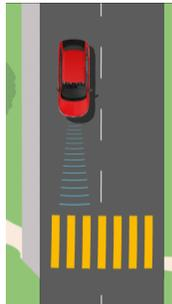
**Front Assist** : Préviens des dangers et des conséquences d'une collision avec le véhicule de devant. Dès que le véhicule se rapproche trop de celui de devant, une alerte sonore et visuelle apparaît. Dans certaines situations critiques, le système peut même amorcer le freinage.
