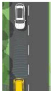
**Régulateur de vitesse adaptatif ACC** : Maintient une vitesse constante et calcule la distance avec le véhicule qui précède. La vitesse est ainsi constamment adaptée en fonction des conditions de circulation. Actif dès 30 km/h
