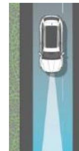
**Lane Assist** : Si votre véhicule s'approche trop du marquage latéral, une correction active de trajectoire s'effectue au niveau de la direction pour éviter tout risque de collision. Actif dès 65 km/h
