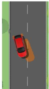
**Freinage anti multi-collisions** : En cas de collision, le système active les freins pour éviter ou atténuer une collision supplémentaire en réduisant de manière autonome la vitesse du véhicule. Dans ce cas, les feux de détresse et feux stop s'activent automatiquement.
