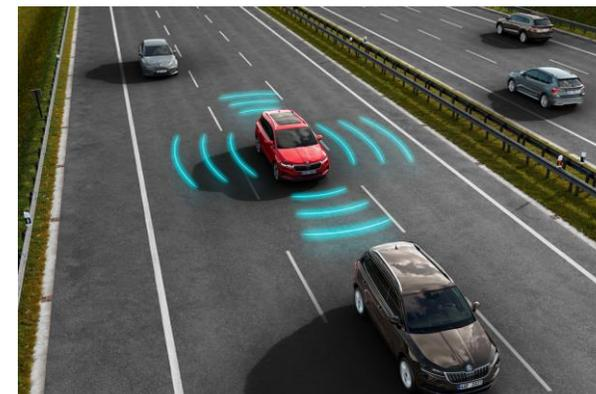
**Emergency Assist :** Si le Lane Assist détecte l'absence des mains du conducteur sur le volant, même après un signal d'alerte, il ralentit la voiture jusqu'à l'arrêt en maintenant dans la voie, avec les feux de détresse allumés. L'assistance d'urgence est disponible pour les véhicules équipés de DSG
