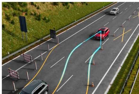
**Assistant de maintien dans la voie (Lane Assist) :** Le Lane Assist adaptatif aide à maintenir le véhicule dans sa voie en ajustant la direction. Si le véhicule s'approche trop du marquage latéral, une correction active de trajectoire s'effectue pour éviter tout risque de collision. Le système est également capable d'identifier le bord de la route et les marquages au sol temporaires
