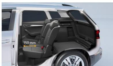
**Amplitude** jusqu'à 15cm d'avant en arrière.
