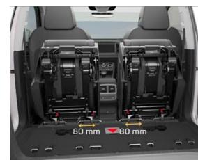
**Rapprochement** possible des 2 sièges arrière latéraux par coulissage.
