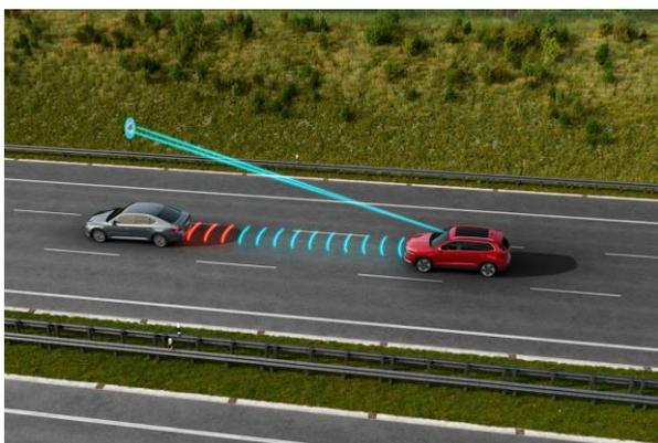
**Régulateur de vitesse Adaptatif et prédictif :** Maintient une vitesse constante et calcule la distance avec le véhicule qui précède. Si besoin, il décélérera de 3,5m/s. Lié au Front Assist, il alertera le conducteur et décélérera jusqu'à 8 m/s selon les conditions de trafic en cas de danger. Il utilise une multitude de systèmes et ajuste également automatiquement la vitesse du véhicule en fonction de la route (avant d'arriver dans un rond-point,...)
