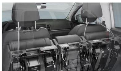
**Sécurisation** de chaque siège relevé par accroche au supports d'appuie-têtes.
