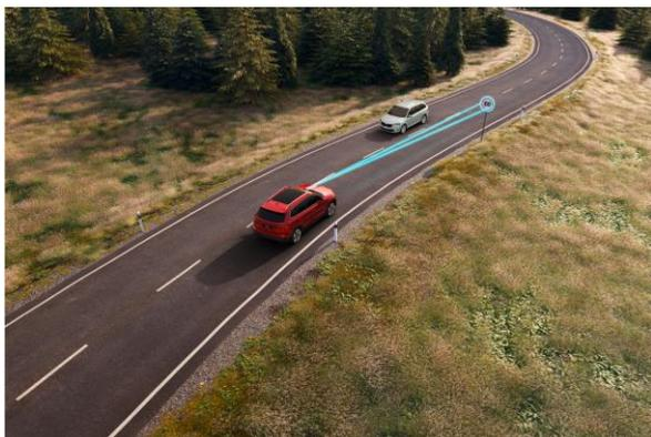
**Reconnaissance des panneaux de signalisation :** Ce système d'assistance compare les panneaux de signalisation situés devant le véhicule (jusqu'à 50 mètres) avec les données du système de navigation.
