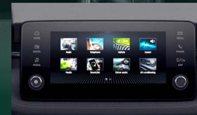
Écran d'info-divertissement 8,25" Bluetooth, 4 haut-parleurs, Radio AM/FM, DAB et 2 ports USB-C 15 W à l'avant
