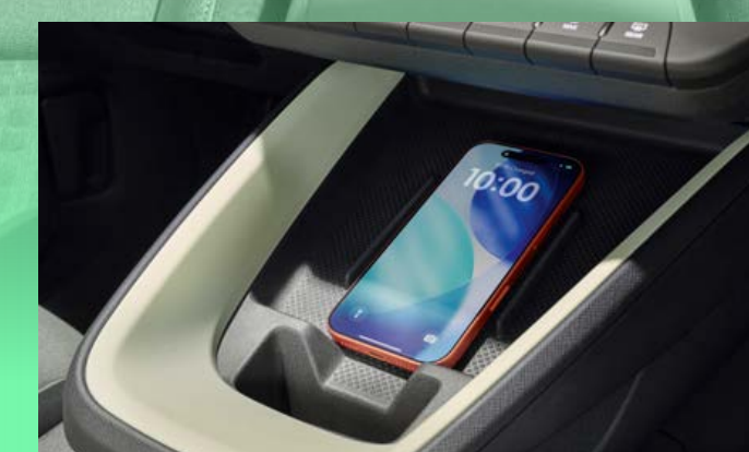
Dispositif Phonebox : recharge par induction magnétique (puissance jusqu'à 25W) et ventilation active
